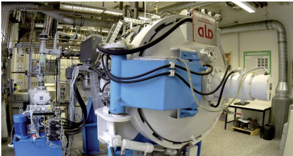
Niederdruck-Ofenanlage zum Härten und Aufkohlen mit integrierter Hochdruck-Gasabschreckung.
